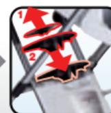
Удалить маленькую чёрную крышку и вставить большую чёрную крышку (= воронка) в заливное отверстие бойлера
