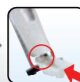
Подставить ёмкость для слива и отвинтить пробку сливного отверстия
