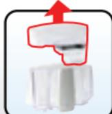
Удалить водяной фильтр и заполнить бак ГОРЯЧЕЙ водопроводной водой до отметки MAX
